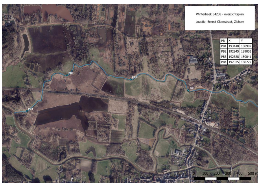
Figuur 1 Geplaatste peilbuizen voor de grondwatermonitoring ter hoogte van de Hulpe
